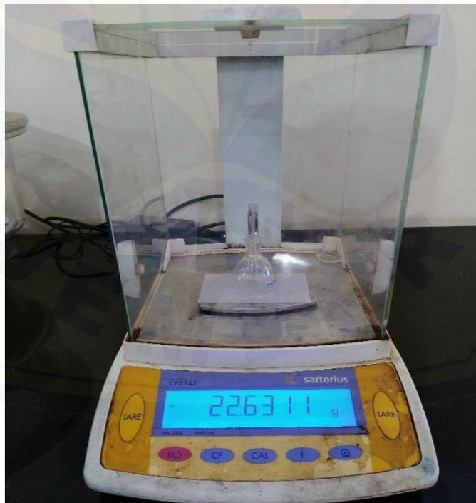
Gambar 5. Proses penimbangan piknometer pada pengujian massa jenis
