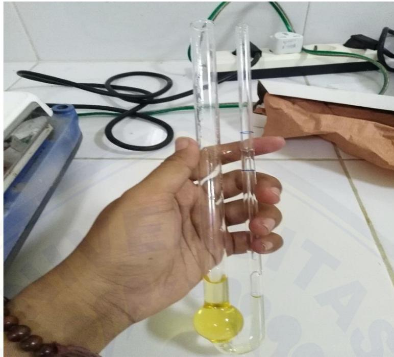
Gambar 6. Viskometer pada pengujian viskositas kinematik
