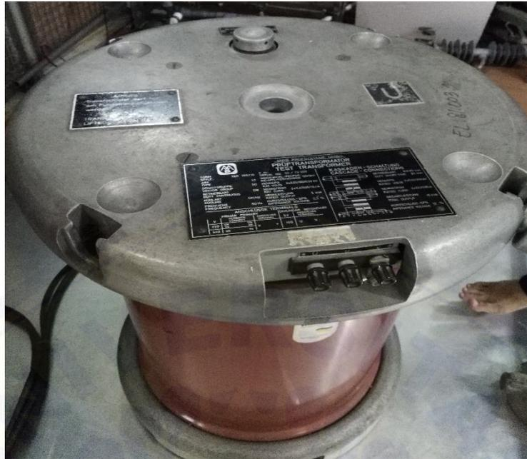
Gambar 5. Transformator uji pada peralatan tegangan tembus
