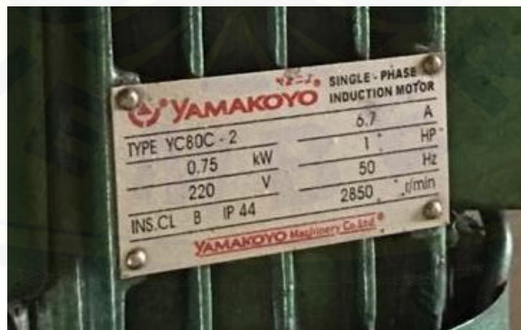
Gambar F.6 Spesifikasi motor listrik
