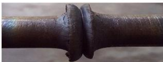
Gambar 2 Tampilan Penampang Horizontal dari Sambungan Las Gesek
