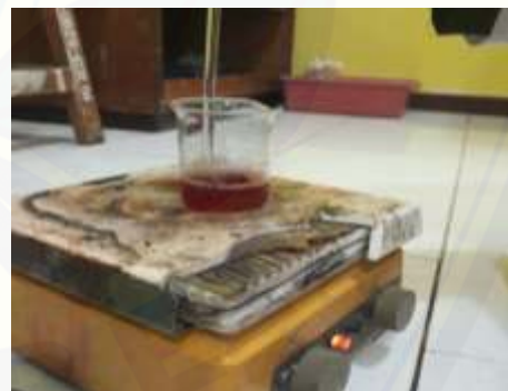
Gambar 20. Pemasakan medium SSA
