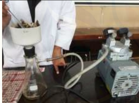
Gambar 11. Penyaringan hasil maserasi
