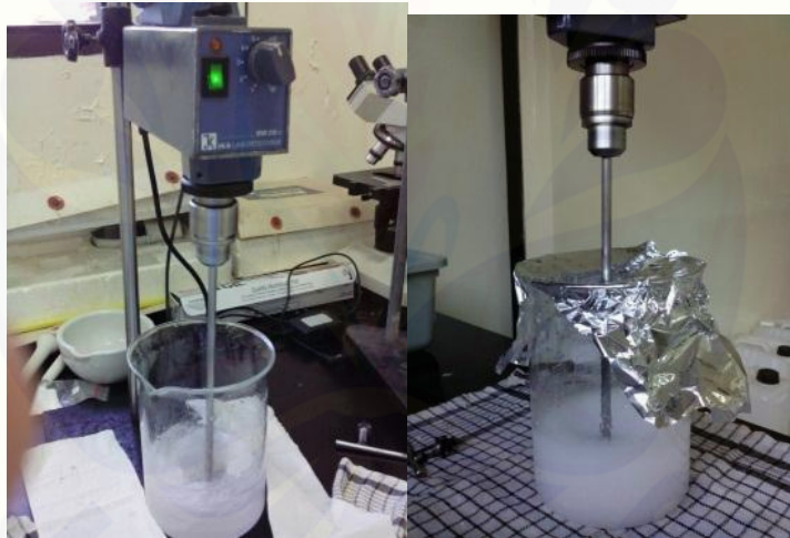
Proses pengadukan fase eksternal kedalam fase internal dengan four blades propeller
