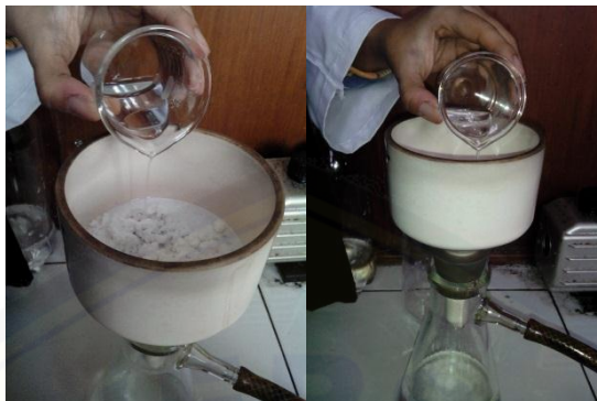
Proses penyaringan microspheres dengan penyaring vakum dan pencucian microspheres dengan petroleum eter
