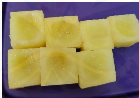
Gambar 3.1 Media uji daya tembus balok kentang dengan cekungan pada bidang tetes berdiameter 1,5 cm dan kedalaman 3mm
