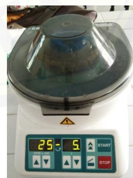
Gambar 4. Tabung disentrifuse kembali dengan kecepatan 2.500 RPM selama 5 menit
