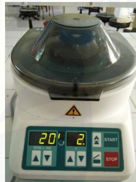
Gambar 4. Tabung disentrifuse dengan kecepatan 2.000 RPM selama 2 menit
