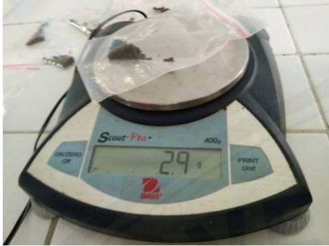
Gambar 1. Pengukuran 2 gram sampel tanah yang akan diperiksa
