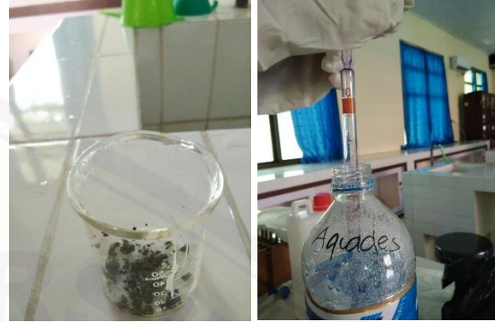
Gambar 2. Sampel 2 gram tanah dilarutkan dengan 10 ml akuades
