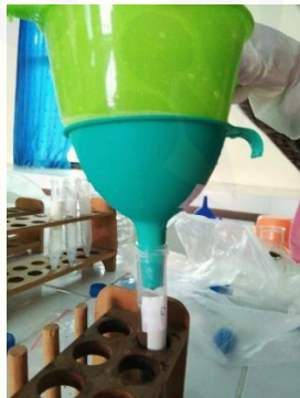
Gambar 3. Sampel tanah dimasukkan ke dalam tabung sentrifuse melalui saringan teh
