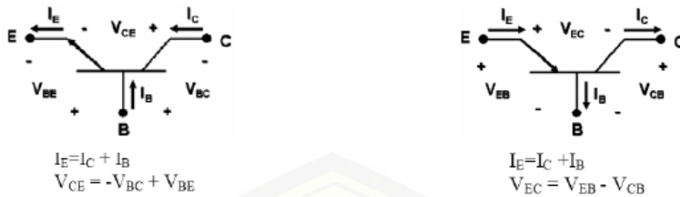
Gambar 2.1 (a) Simbol Hubungan Arus dan Tegangan untuk Tipe NPN; (b) Simbol Hubungan Arus dan Tegangan untuk Tipe PNP (Debataraja, 2011 : 2).
