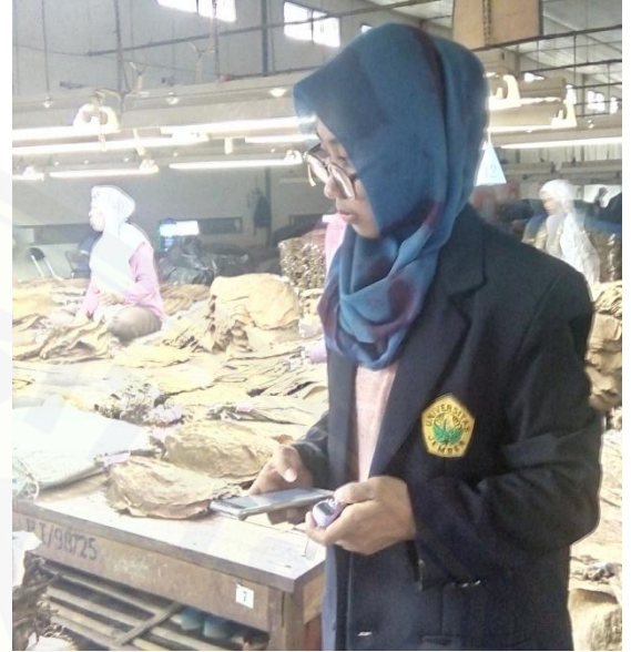
Gambar 2. Pengukuran repetitive motion menggunakan digital counter dan stopwatch
