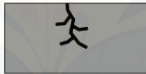
Gambar 2.6 Korosi Retak Tegang (Sumber : Roberge, 1999)
