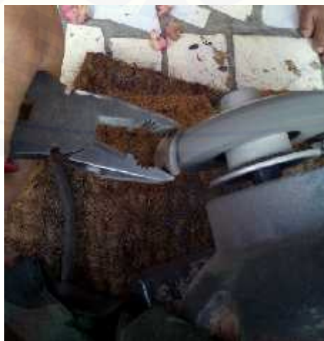
Penghalusan Permukaan Spesimen
