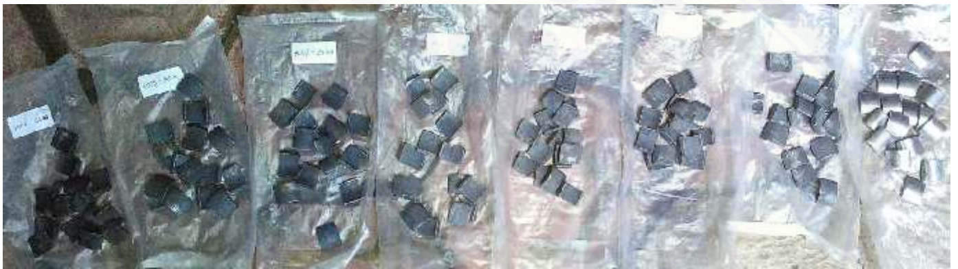
Spesimen Setelah Dilakukan Perlakuan Panas Quenching dan Tempering
