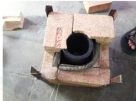
Pemasangan krusible didalam dapur peleburan
