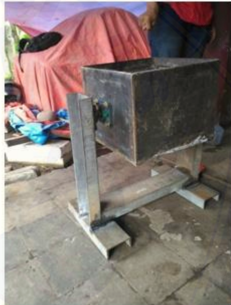
Rangka dapur pengecoran
