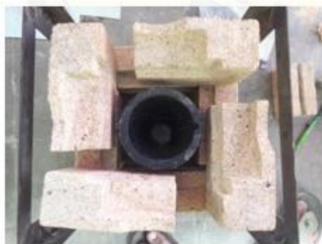
Proses pemasangan krusible
