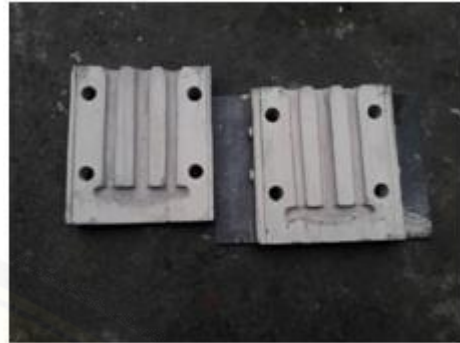
Cetakan setelah dicoating dengan mortar
