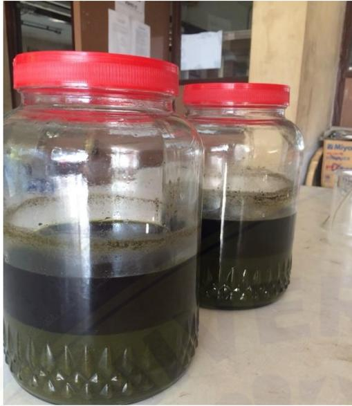
Proses Maserasi dengan Pelarut Etanol 70%
