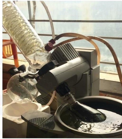
Proses evaporasi etanol 70% dengan *rotatory evaporator*
