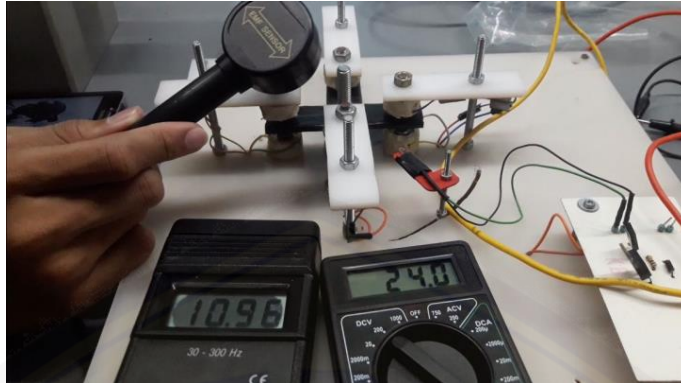
Gambar pengukuran medan magnet tegangan 24 volt pada posisi sudut reed switch 35° kanan kumparan
