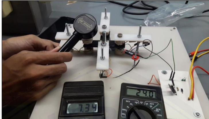
Gambar pengukuran medan magnet tegangan 24 volt pada posisi sudut reed switch 25° kiri kumparan
