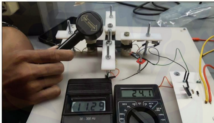
Gambar pengukuran medan magnet tegangan 24 volt pada posisi sudut reed switch 35° kiri kumparan
