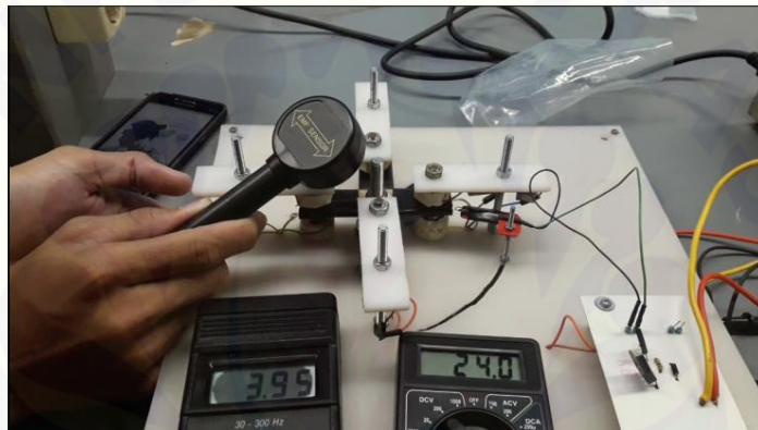
Gambar pengukuran medan magnet tegangan 24 volt pada posisi sudut reed switch 5° kiri kumparan
