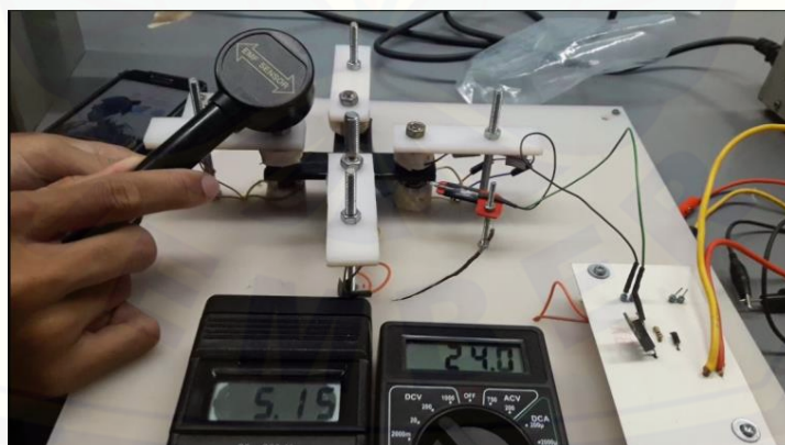
Gambar pengukuran medan magnet tegangan 24 volt pada posisi sudut reed switch 15° kiri kumparan
