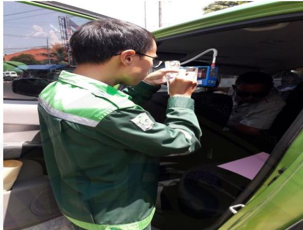
Gambar 4. Persiapan Penempatan Alat Ukur Benzena
