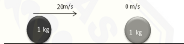
Gambar 2.1 dua buah benda dengan massa yang sama ditumbukkan dengan salah satu benda diam dengan benda lain diberikan kecepatan.
