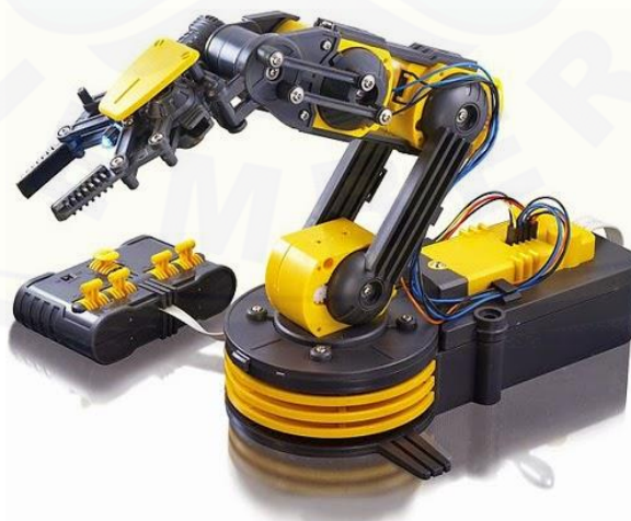
Gambar 2.1 Robot Lengan dengan Gripper (Sumber: Tirto Wirjaso,2015)
