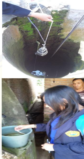
Pengambilan sampel dan pengukuran pH air sumur
