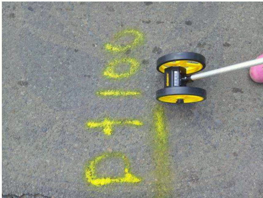
D.2 STA 0+100 Segmen Jalan Hasil Pengukuran
