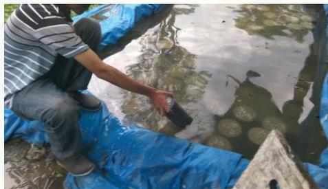
Gambar A.4. Tahap Perawatan Benda Uji
