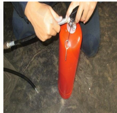
Gambar 8. Memasang cob transfer udara pada tabung APAR dan pada kompresor
