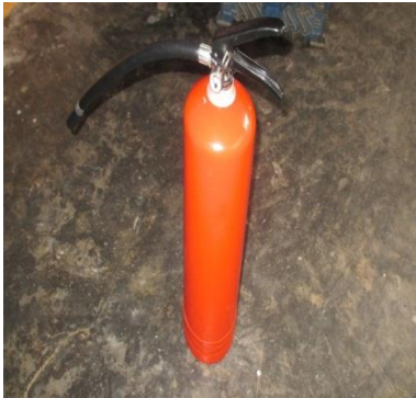
Gambar 9. Tabung APAR sudah siap di gunakan dalam memadamkan kebakaran kelas B dengan bahan bakar premium 0,5 liter
