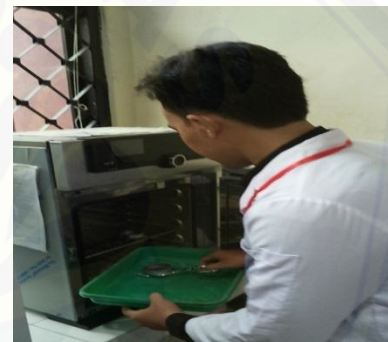
Gambar 4. Mematikan oven, dan mengambil sampel pasir
