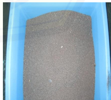
Gambar 2. Menyiapkan pasir yang telah dikeringkan secara manual selama 3 hari.
