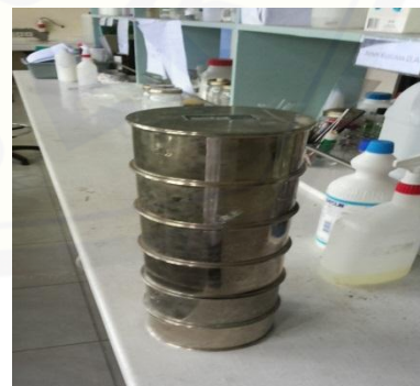
Gambar 2. Susunan seri saringan ASTM dari atas ke bawah harus di susun mulai dari diameter besar – kecil
