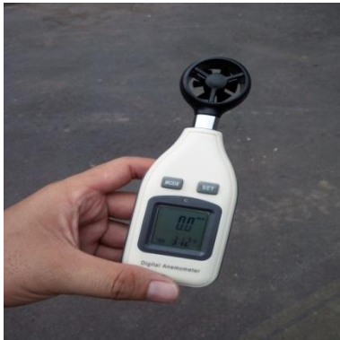
Gambar 5. Mengukur kecepatan angin pada lokasi pemadaman
