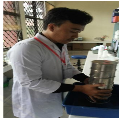
Gambar 4. Kocok dengan arah kanan-kiri secara berulang selama 10 menit
