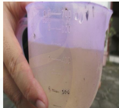
Gambar 2. Menakar premium dengan volume 0,5 liter dengan menggunakan wadah ukur
