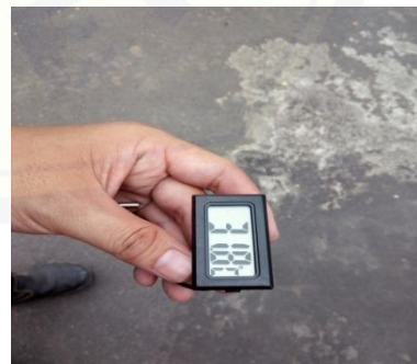
Gambar 4. Mengukur temperatur lokasi pemadaman
