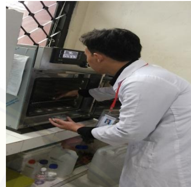
Gambar 2. Memasukan sampel pasir pada oven
