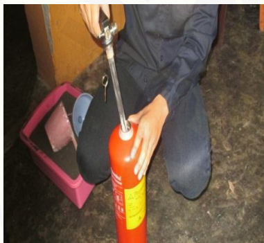
Gambar 1. Membuka tuas nozzle
