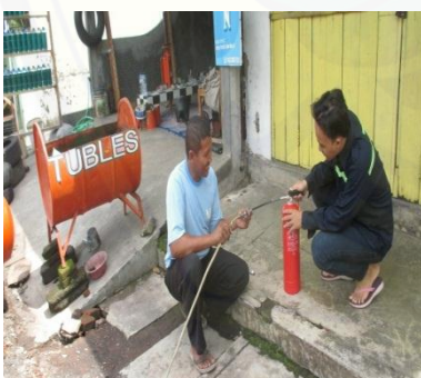
Gambar 9. Memperhatikan pressure gauge Tabung APAR pada saat pengisian
