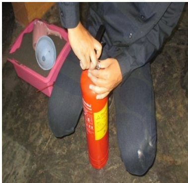
Gambar 7. Tutup kembali secara rapat tuas nozzle
