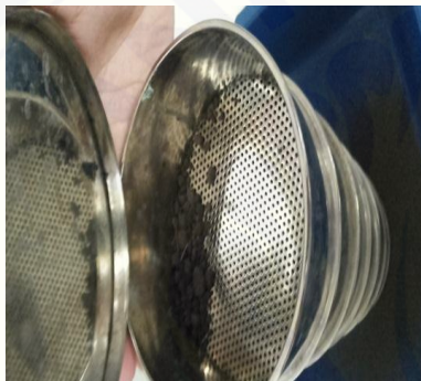
Gambar 5. Menganalisis tiap pasir yang tertahan dan lolos pada tiap seri saringan
