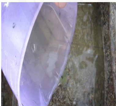
Gambar 3. Menyiramkan premium yang telah ditakar pada wadah penampung
