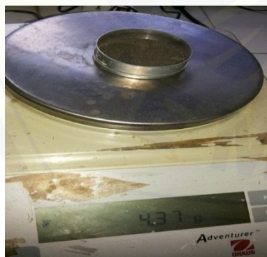
Gambar 5. Hasil kadar air pasir sebelum dikeringkan
