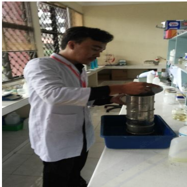
Gambar 3. Memasukkan 200 gram pasir pada susunan saringan ASTM
