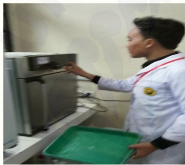
Gambar 3. Mengatur suhu pemanasan 105 °C pada oven digital (setelah itu, tunggu proses pemanasan hingga 1 jam)
