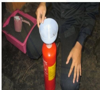
Gambar 3. Masukan corong pada lubang tabung APAR
