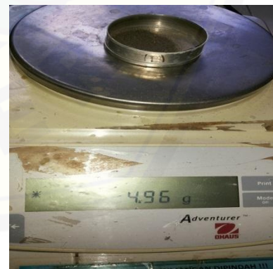
Gambar 6. Hasil kadar air pasir setelah dikeringkan manual selama 3 hari
