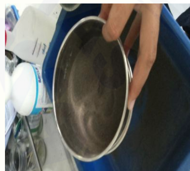
Gambar 6. Pada seri ke 80 mesh pasir banyak yang lolos, dan seri di bawahnya 80 mesh yang lolos sebesar 0 gram.
