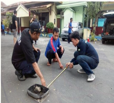
Gambar 1. Mengukur jarak penyemprotan dan wadah penampung kebakaran
