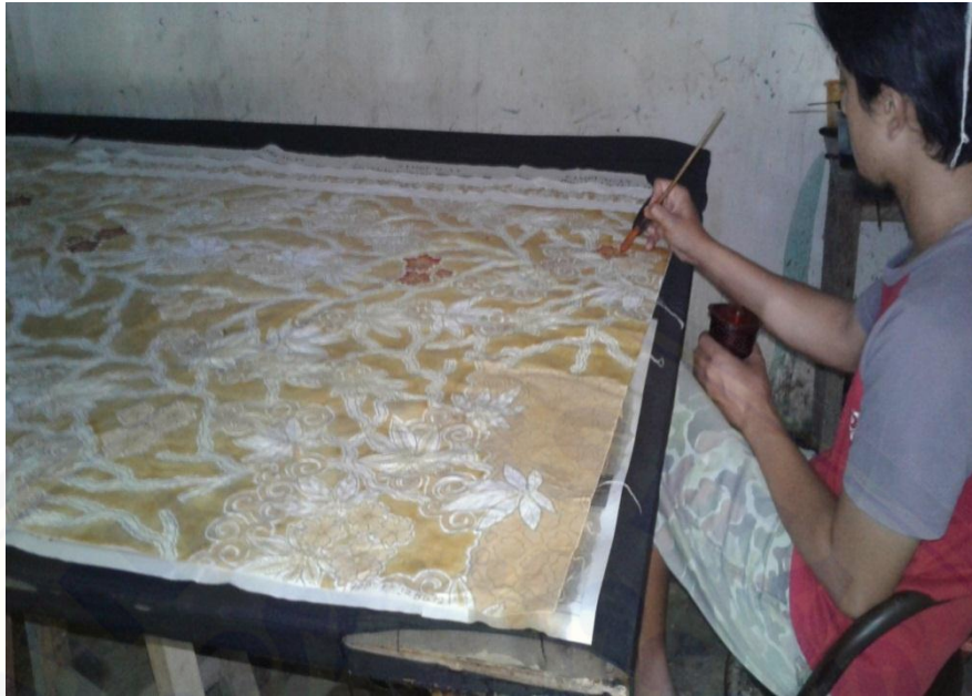
Gambar G.3 : Proses colet (Pewarnaan pada kain Batik yang sudah selesai pencantingan)
