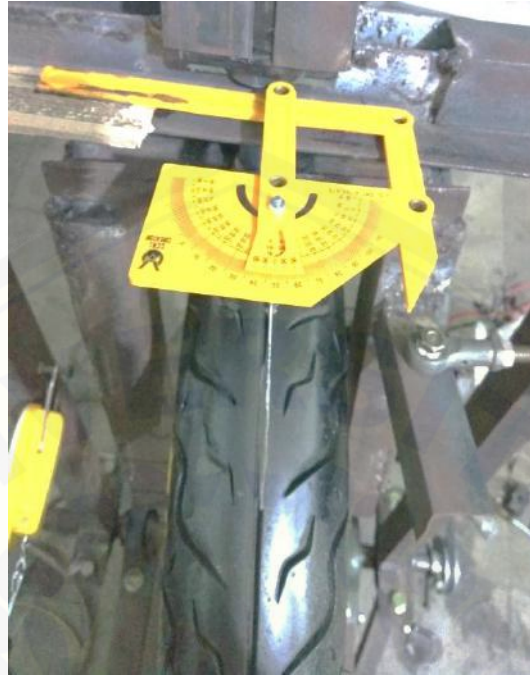
Gambar C.3 Busur derajat (alat ukur sudut slip)
