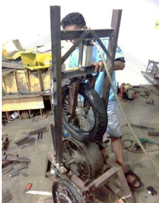
Gambar C.1 Foto pemasangan ban yang akan diuji
