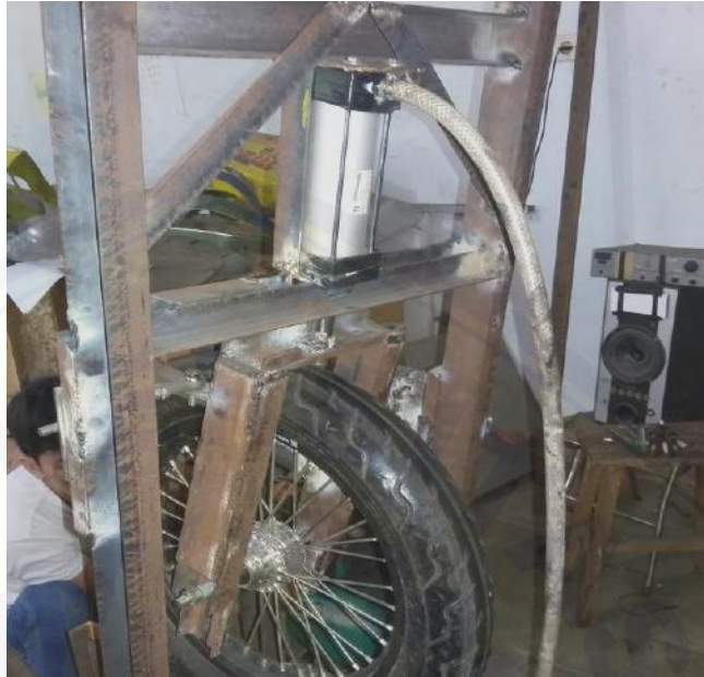
Gambar 3.3 Skema pemberian beban dengan silinder pneumatik (ruang riset tim mobil listrik Titen, LPM UNEJ)
