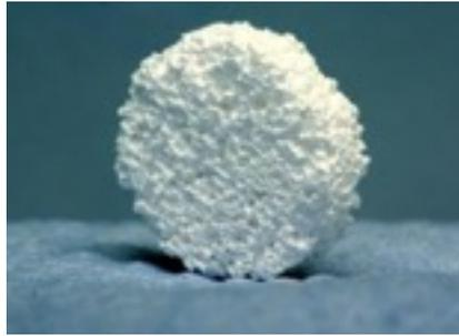
Gambar 7. Scaffold yang dihasilkan berbentuk silindris dengan diameter 5 mm dan tebal 3 mm.
