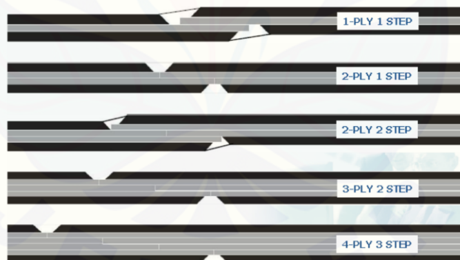
Gambar 2.8 Jumlah ply dan cara penyambungan (Summa learning center, 2001)
