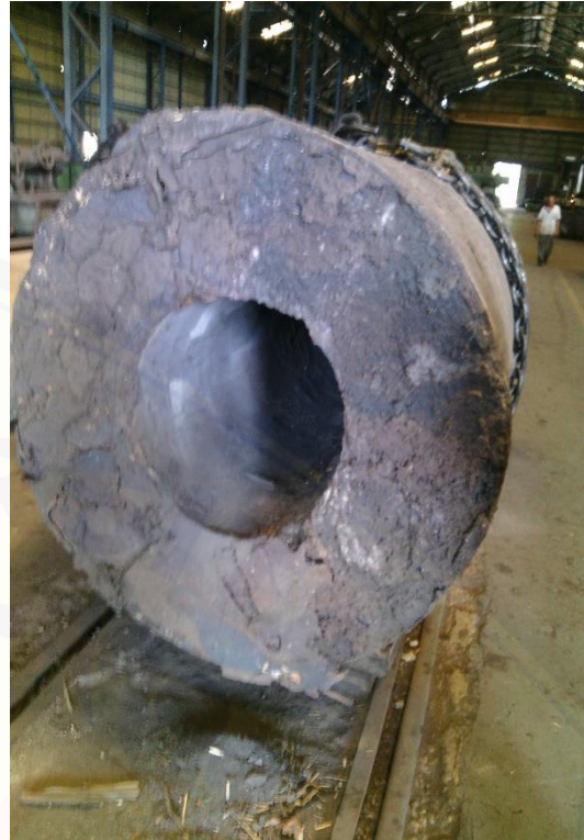
Mill roller sebelum di boring
