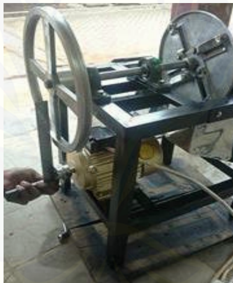
Gambar C.8 Penyetelan pulley dan sabuk
