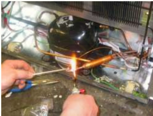
Pemasanan Filter dan Pipa Kapiler
