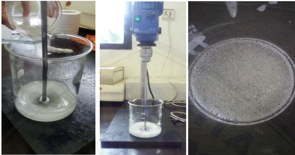
Proses pencampuran fase eksternal kedalam fase internal, proses pengadukan dengan four blades propeller dan emulsi yang terbentuk
