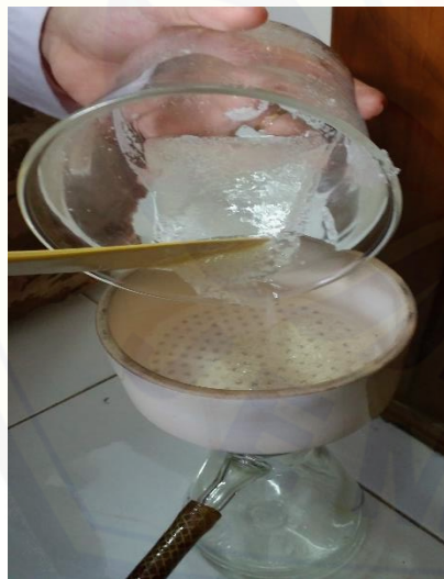
Proses penyaringan microspheres dengan penyaring vakum
