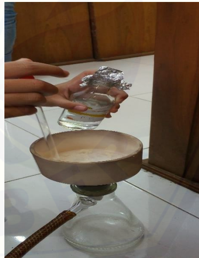
Proses pencucian microspheres dengan petroleum eter
