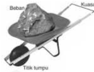
Gambar 2.4 letak titik tumpu, beban dan titik kuasa pada gerobak roda satu
