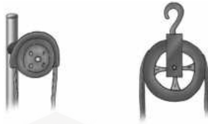
Gambar 3.1 contoh penggunaan katrol tetap, (a) katrol tiang bendera (b) katrol pada sumur timba
