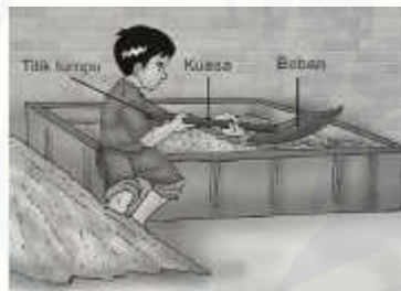
Gambar 2.5 sekop adalah contoh tuas golongan ketiga
