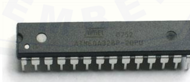
Gambar 2.10 Mikrokontroler ATmega328 (Sumber: Fatwanto, 2013)
