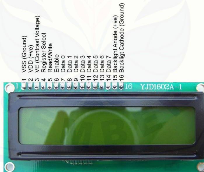
Gambar 2.13 LCD 2 x 16 (sumber: Aliexpress, 2015)
