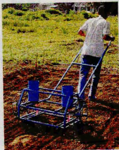
Gambar 2: Operasi penanaman biji jagung saat pengujian alat
