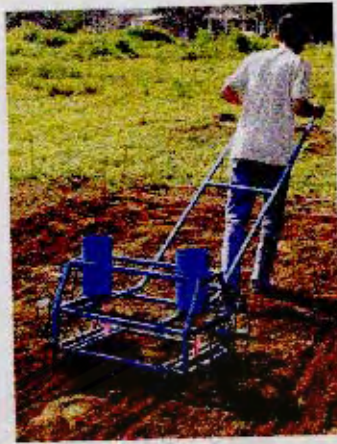
Gambar 5.3: Operasi Penanaman Biji Jagung saat Pengujian Alat
