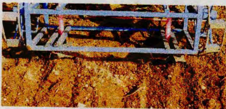
Gambar 5: Proses pembukaan dan penutup alur pada alat tanam
