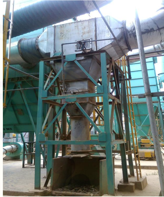
Gambar 4.6 Mesin Bag Filter setelah dilakukan pembersihan
