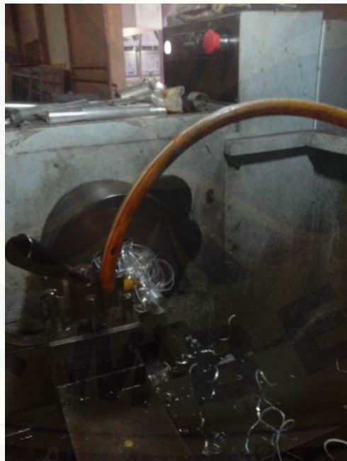
Gambar 4.6 Geram Hasil Pembubutan Yang Melilit Pada Permukaan Benda Kerja
