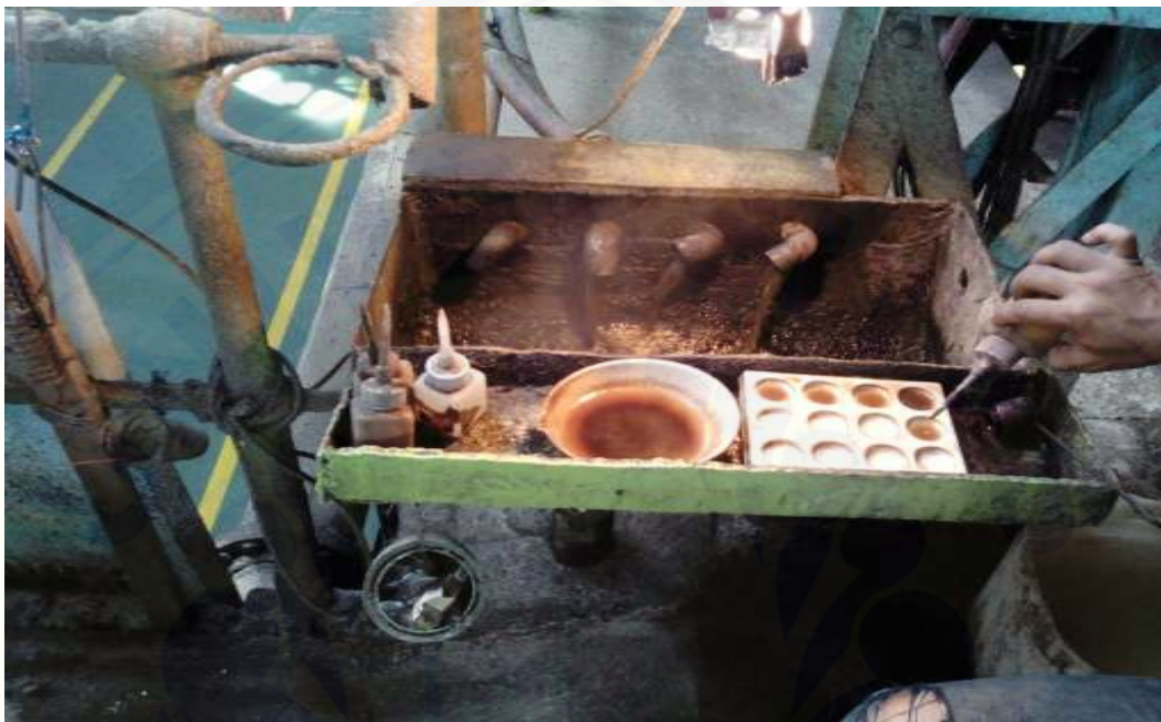
Gambar 4.10 Pemberian Belerang Pada Proses Pemurnian
