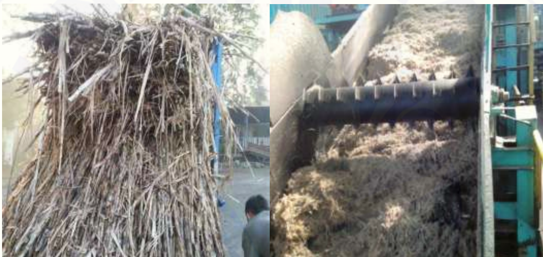
Gambar 4.8 Proses Pengangkutan dan Penggilingan Tebu
