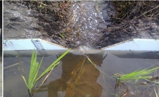
Gambar 14. Penempatan sekat ukur Thompson di lahan
