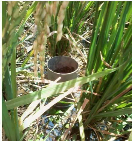
Gambar 15. Alat ukur perkolasi
