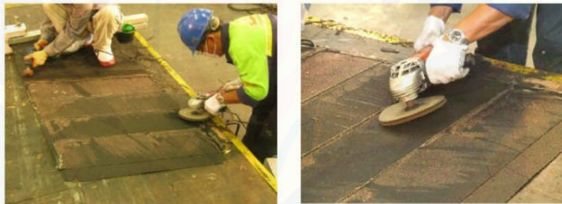
Gambar 3.17 Proses pengasaran karet yang terdapat fabric
