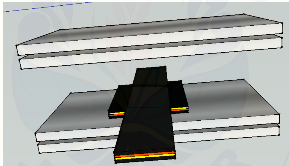
Gambar 3.25 Belt di jepit di antara dua heater (pemanas)
