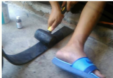
Gambar 3.22 Proses perekatan belt dengan bantuan palu karet
