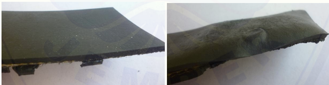
Gambar 4.8 Bentuk fisik karet belt setelah dilakukan proses pemanasan, (a) suhu pemanasan 130°C dan 150°C, (b) suhu pemanasan 170°C
