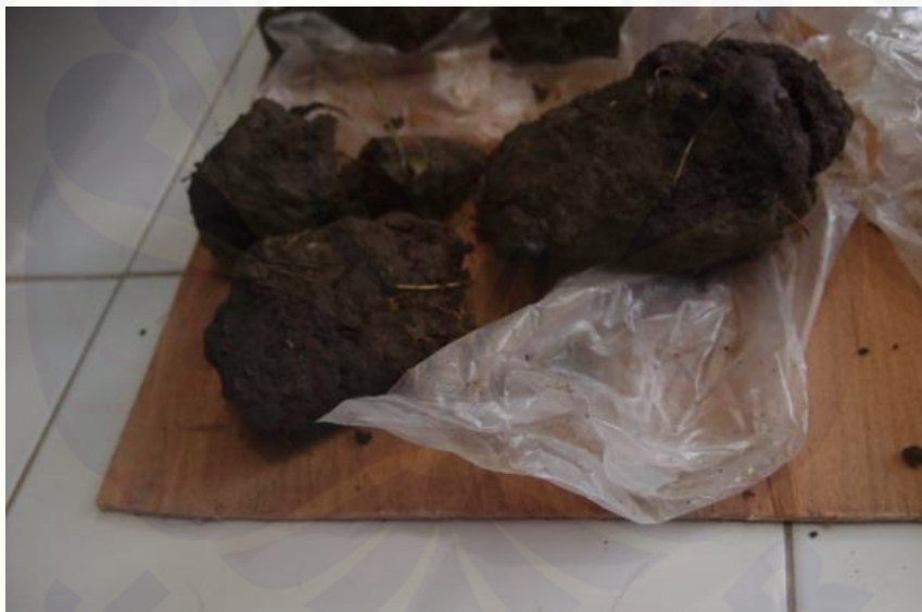
Gambar 4.2 Bongkahan Tanah Dari Pengolahan (K1) 396 Rpm
