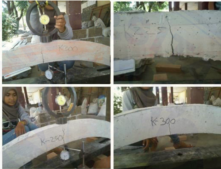
Gambar 4.2 Balok lengkung yang mengalami keruntuhan
