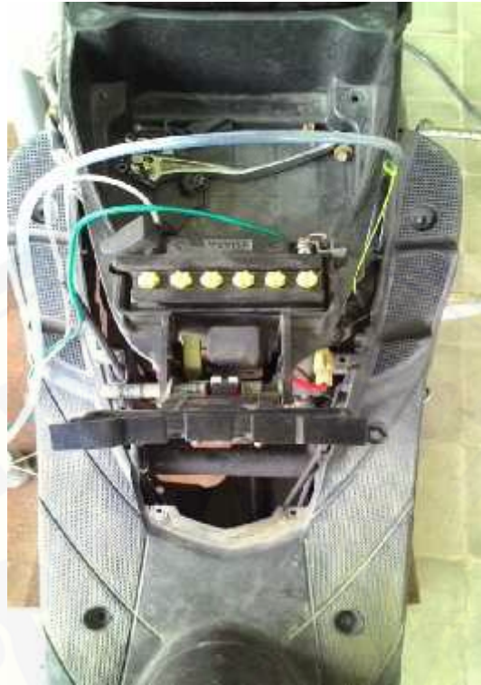
Gambar Pemasangan Kabel pada Aki
