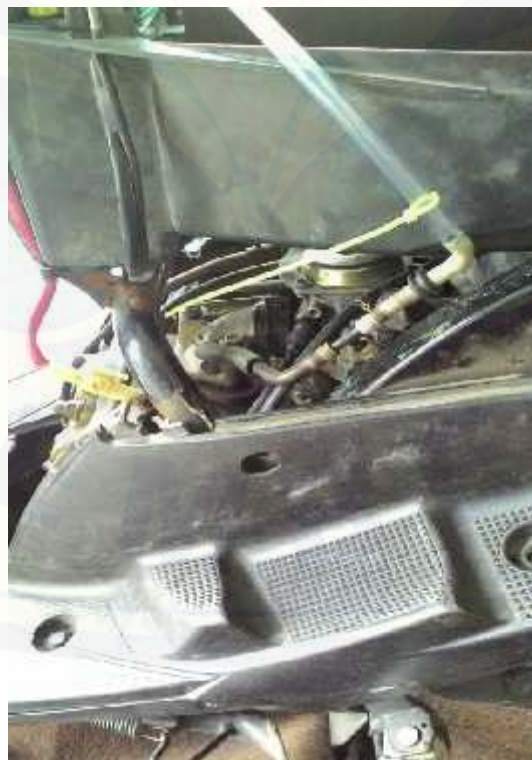
Gambar Pemasangan Selang Pada Intake Manifold
