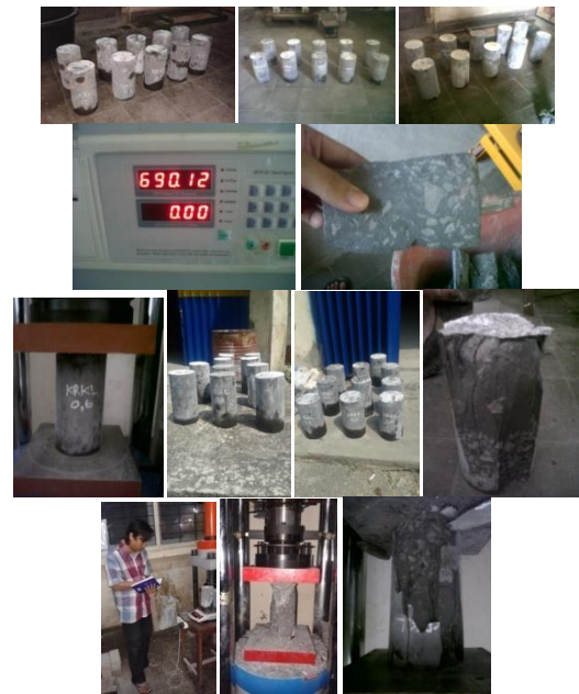
Gambar 7. Pengujian pengaruh komposisi pasir dan kerikil terhadap kuat tekan beton UHPC
