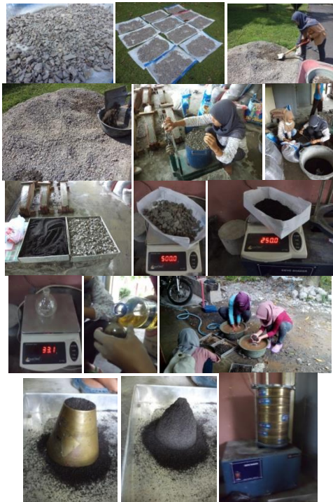
Gambar 5. Pengujian sifat bahan penyusun beton UHPC
