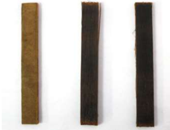
Gambar 1 Tipikal bahan biokomposit hasil sintesis sebelum dilakukan uji kekuatan tarik.
