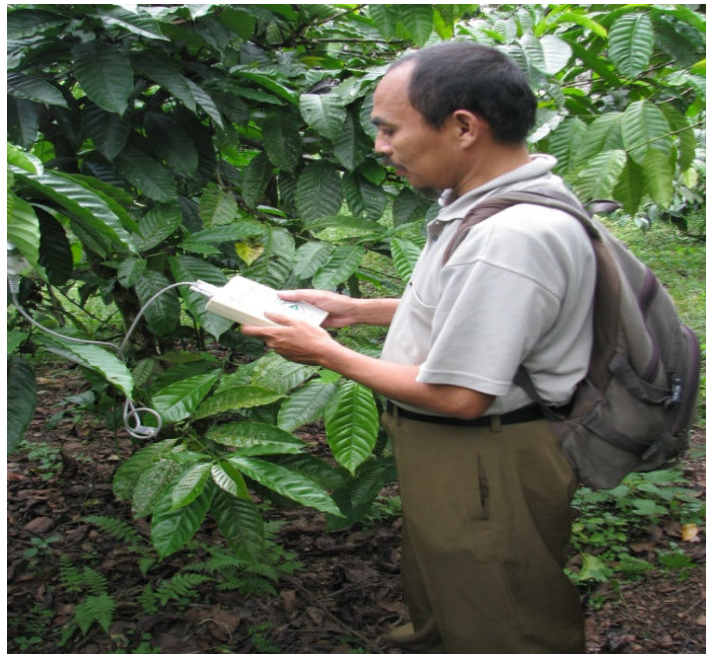
Pengambilan data penelitian dengan menggunakan Leaf Porometer
