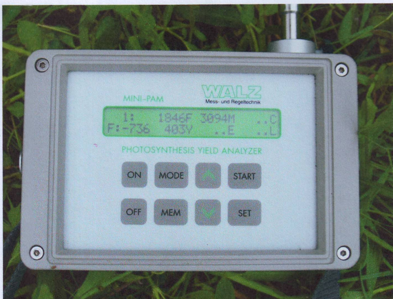
Keterangan : Mini-PAM Untuk Mengukur Laju Fotosintesis
