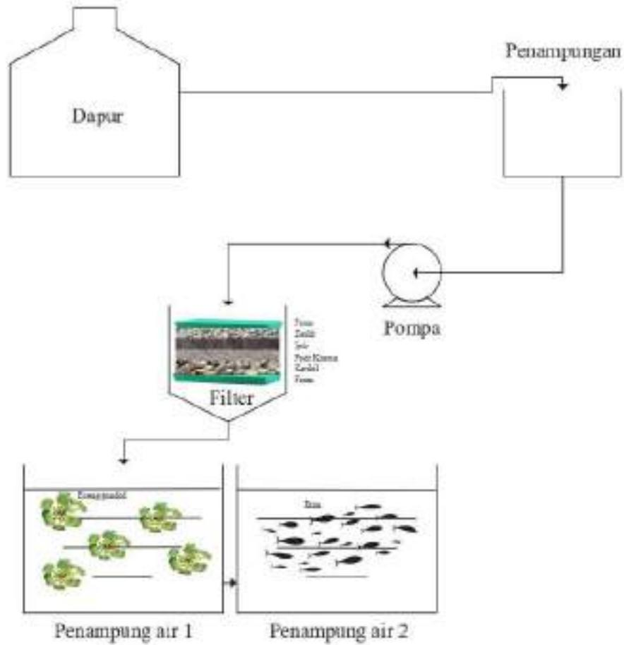
Gambar 3. Skema rancangan teknologi tepat guna mesin pengolah limbah cair tempe
