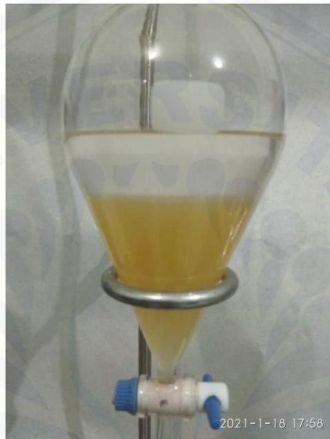
Gambar 4.7 Proses Ekstraksi Cair-Cair Menggunakan Corong Pisah Sehingga Terbentuk 2 Fase: Fase Etil Asetat (Atas) dan Fase Air (Bawah).
