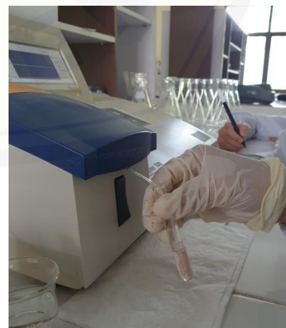
Pengukuran kadar kolesterol menggunakan spektrofotometer
