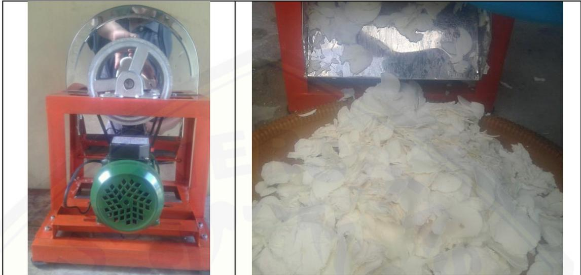
**Gambar 3.** Mesin pemotong krupuk singkong
