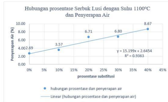
Gambar 2. (a) Hasil Uji Resapan Air dengan Suhu 900°C (b) Hasil Uji Resapan Air dengan Suhu 1000°C (c) Hasil Uji Resapan Air dengan Suhu 1100°C
