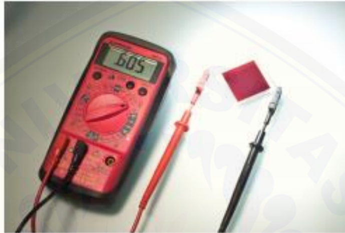
Gambar 2.14 Pengujian arus dan tegangan dari DSSC (Martineau, 2012)
