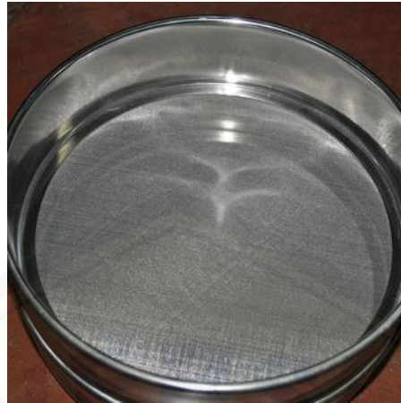
Gambar 3.4 Saringan dengan ukuran Mesh 80 (177 \mu\text{m} )
