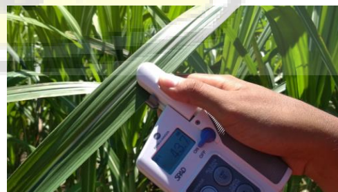
Gambar 3.5 Pengambilan data kandungan klorofil dengan SPAD
